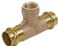
NIBCO Copper/Bronze Tee PC612/PC712 • ½"–4": 200 PSI CWP • P x P x F
