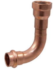
NIBCO Copper 90° Elbow PC607-3 • ½"–2": 200 PSI CWP • P x F
